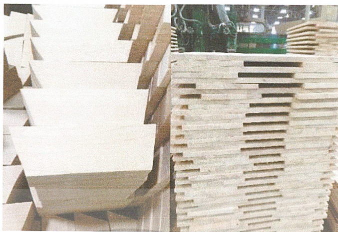
ภาพที่ 2.14 การทำชิ้นส่วนไม้เพื่อใช้ในการประสานผลิตภัณฑ์ต่อไป
