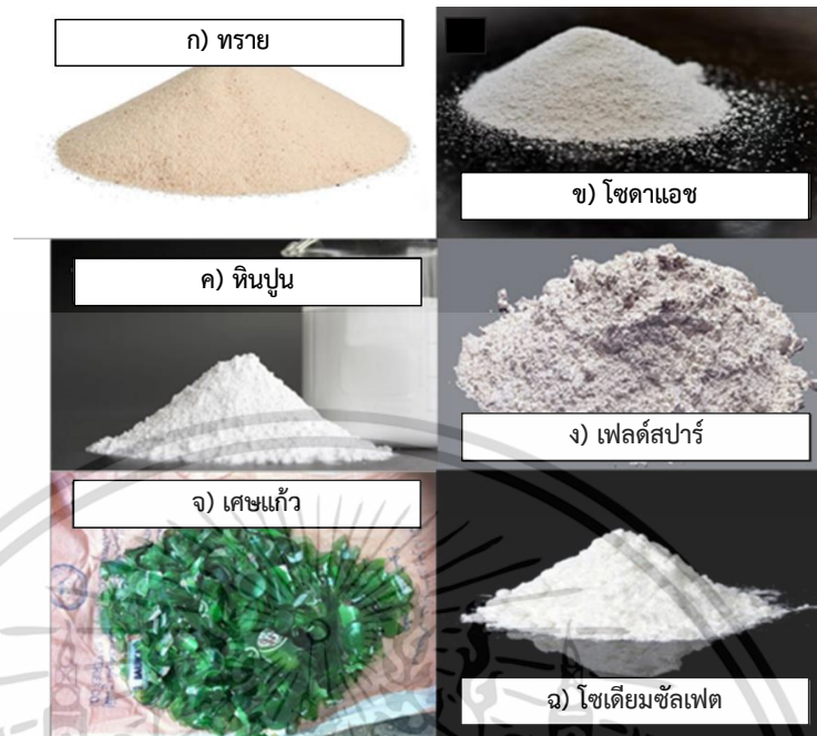
รูปที่ 3.5 วัตถุดิบที่ใช้ในการผสมสำหรับการผลิตขวดแก้ว
