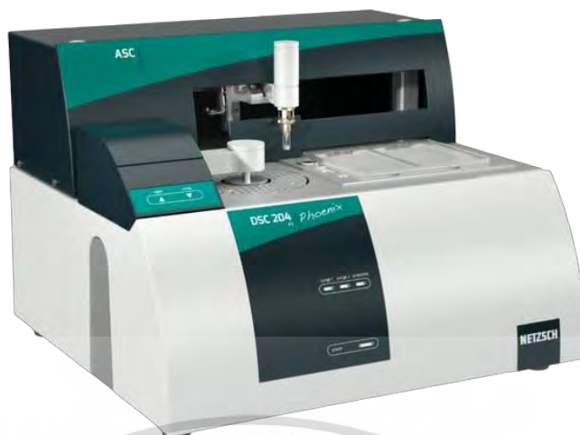
รูปที่ 3.7 เครื่อง DSC (DSC 204 F1 Phoenix, NETZSCH)
