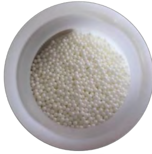
รูปที่ 3.2 ลูกบด Zirconia สำหรับกระบวนการผสมแบบ Ball-Milling
