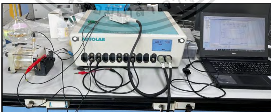
รูปที่ 3.9 การดำเนินการทดสอบการกัดกร่อนทางเคมีไฟฟ้า
