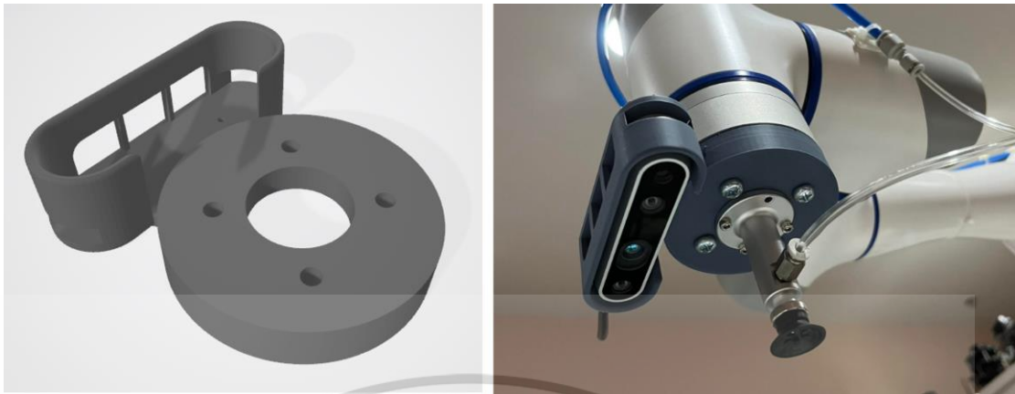
รูปที่ 3.12 อุปกรณ์ที่ใช้ในการติดตั้งกล่องเข้ากับปลายแขนของหุ่นยนต์
