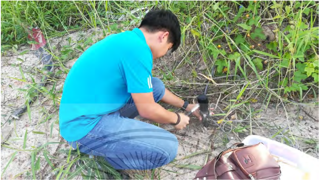
รูปที่ 8-9 การติดตั้งหมุดวัดแรงสั่นสะเทือน
