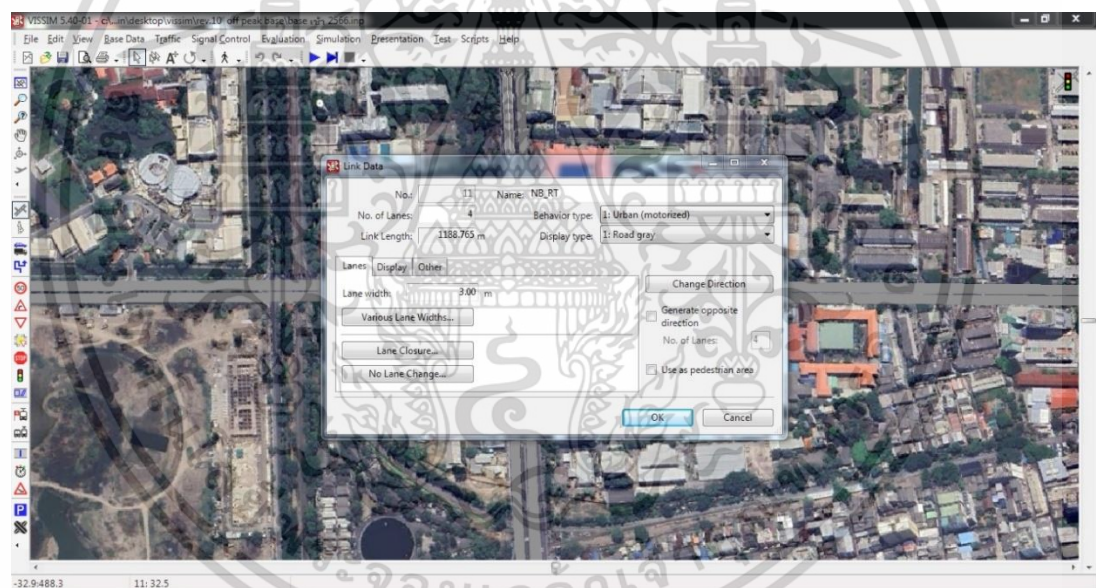
รูปที่ 3.8 การสร้างโครงข่ายถนน (Link & Connector) โดยใช้โปรแกรม VISSIM (ต่อ)
