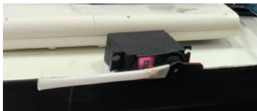
รูปที่ 4.21 เซอร์โวมอเตอร์ยังคงอยู่ที่มุม 180 องศา (ไม้กั้นปิด)
