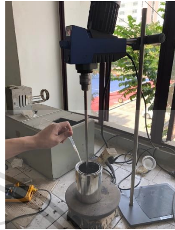
รูปที่ 3.3.2 การผสมยางมะตอยกับผง
