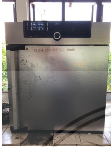
รูปที่ 3.3.1 การอบยางมะตอยในตู้อบ
