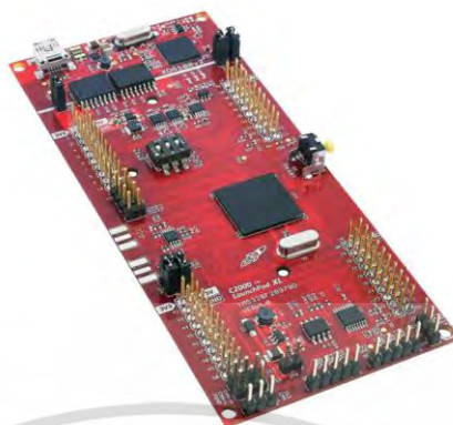
รูปที่ 5.12 ไมโครคอนโทรลเลอร์แบบ Launch Pad เบอร์ TMS320F28379D
