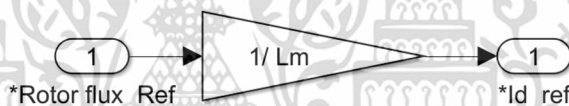
รูปที่ 5.13 บล็อกฟังก์ชัน Gian สร้างสมการกระแสอ้างอิงในแกน d
