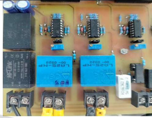
วงจรตรวจจับสัญญาณกระแส AC
