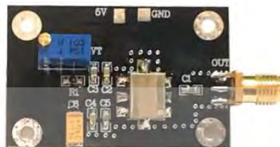
รูปที่ 2.18 ออสซิลเลเตอร์ควบคุมด้วยแรงดันไฟฟ้า (VCO)
