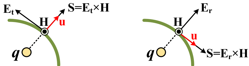
ก) เวกเตอร์สนามไฟฟ้าตามแนวสัมผัส E_t ข) เวกเตอร์สนามไฟฟ้าตามแนวสัมผัส E_r รูปที่ 2.14 ความสัมพันธ์ระหว่างเวกเตอร์พอยน์ดิงและองค์ประกอบของเวกเตอร์สนามไฟฟ้า
