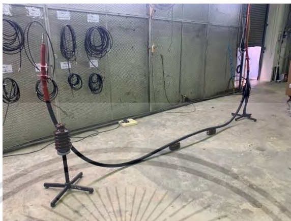
รูปที่ 4.7 ตัวอย่างระบบสายเคเบิลใต้ดินพิกัด 22 กิโลโวลต์สำหรับกรณีศึกษาที่ 2
