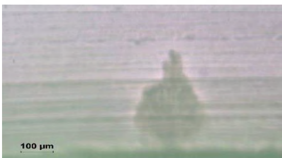
รูปที่ 3.1 ตัวอย่างของต้นไม้ที่พบในสายเคเบิลใต้ดินที่ใช้ทดสอบ [37]
