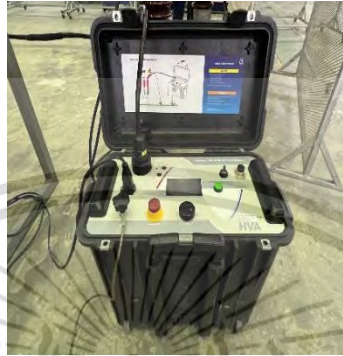
รูปที่ 3.11 เครื่องมือทดสอบ b2 HVA45TD สำหรับการทดสอบแรงดันสูงที่ความถี่ต่ำมาก
