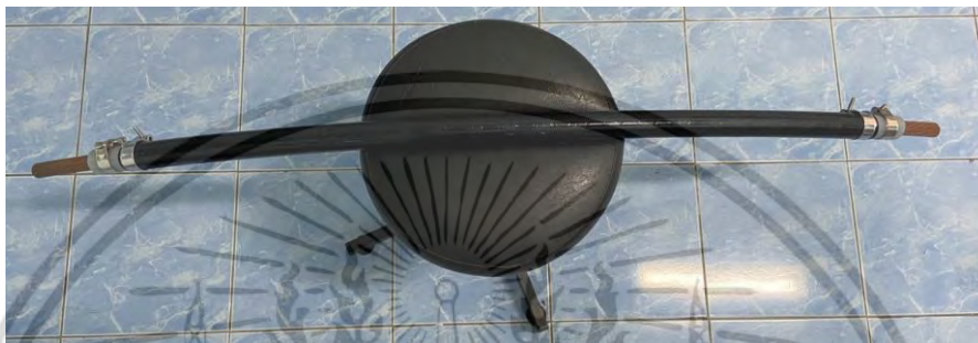
รูปที่ 4.4 สายเคเบิลใต้ดินสำหรับการทดสอบที่ผ่านการปกแล้วโดยนำส่วนประกอบอื่นๆออกโดยมีชั้นชีลด์ฉนวนเป็นชั้นนอกสุด
