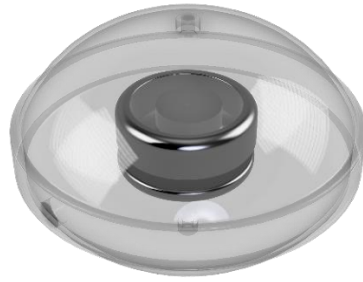
รูปที่ 3.2 แบบ 3 มิติประกอบสำเร็จของชุดเซลล์ทดสอบ
