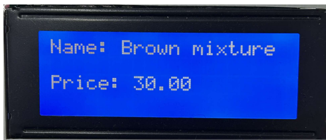
รูปที่ 4.17 ผลการทดสอบ ID: 33B47B บนหน้าจอ LCD ที่ประกอบด้วย ชื่อและราคา
