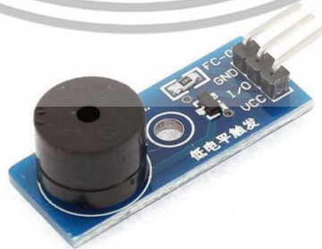
รูปภาพที่ 2.15 ลักษณะของ Passive Buzzer Module [14]
