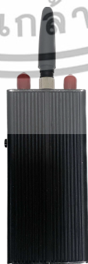
รูปที่ 2.1 อุปกรณ์รบกวนสัญญาณแบบ SMA - Battery
