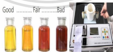
รูปที่ 2. 9 ตัวอย่างน้ำมันหม้อแปลง [10]
