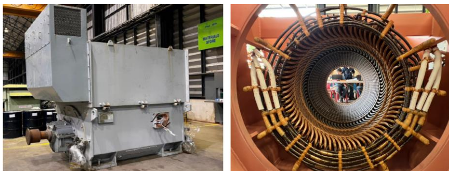
รูปที่ 3.9 มอเตอร์เหนี่ยวนำและขดลวดสเตเตอร์ พิกัดกำลัง 2.8 MW พิกัดแรงดัน 6.9 kV
