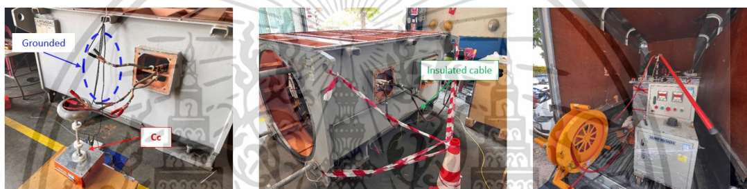
(ก) ตัวเก็บประจุคัปเปิล (ข) ขดลวดที่เชื่อมต่อแรงดันทดสอบ (ค) แหล่งจ่ายแรงดันแบบเคลื่อนที่
