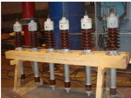
รูปที่ 3.1 การตั้ง OIP บุษชิงบนแท่นวางเป็นเวลา 24 ชั่วโมงก่อนการทดสอบ
