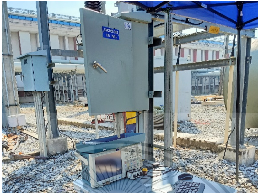
รูปที่ 4.3 การวัดขนาดและรูปคลื่นของแรงดันที่บัส 22 kV โดยใช้ฮอสซิลโลสโคปเชื่อมต่อผ่านขดลวดแรงต่ำของหม้อแปลงวัดแรงดัน
