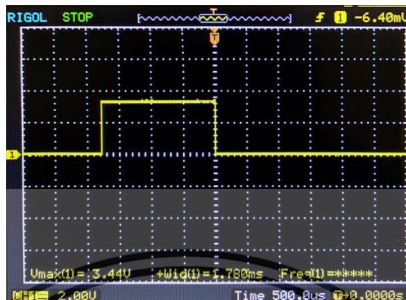
รูปที่ 4.32 ผลการทำงานมอเตอร์ M1 เมื่อได้รับข้อความ left
