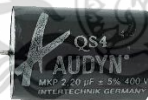
รูปที่ 3.18 ตัวเก็บประจุที่ใช้เป็นชุดคาปาซิเตอร์แบ่งแรงดันในวงจรคอนเวอร์เตอร์
