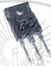
รูปที่ 3.17 มอสเฟตกำลังเบอร์ IRFP460 พิกัด 20 A 500 V
