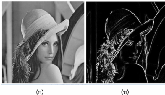
รูปที่ 2.35 ผลลัพธ์การคอนโวลูชัน (ก) ภาพขาเข้า (ข) Feature map ที่ได้จาก Convolution layer
