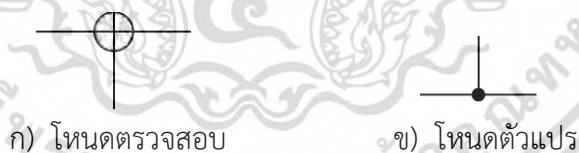
ภาพที่ 2.12 ตัวดำเนินการโหนดตรวจสอบและโหนดตัวแปรในโครงสร้างการถอดรหัสที่กล่าวถึงข้างต้น
