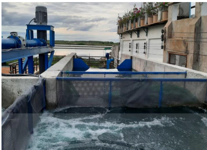
รูปที่ 6.14 บ่อน้ำของการวัดอัตราการไหลด้วยฝายน้ำล้นสำหรับชุดทดสอบในรูปแบบภาคสนาม
