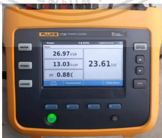
รูปที่ 6.17 เครื่องมือบันทึกคุณภาพกำลังไฟฟ้าสามเฟส
