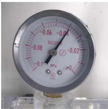
ภาพที่ 4.2 ภาพแสดงเกจวัดค่าสภาวะสุญญากาศขณะใช้งานอยู่ที่ 0.04 เมกะปาสคาล (MPa)
