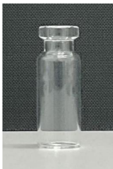
ภาพที่ 2.1 ภาพแสดงขวดแก้วขนาด 3 มิลลิลิตร ประเภท I (type I)
