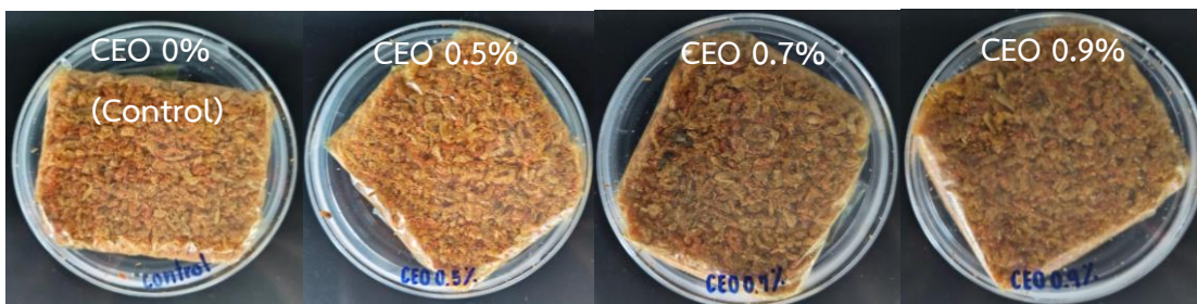
รูปที่ 4-4 การทดลองใช้ฟิล์มโคโตซาน-เจลาตินผสมน้ำมันหอมระเหยอบเชย(Cinnamon Essential Oil: CEO) ความเข้มข้นต่างกันเป็นบรรจุภัณฑ์กึ่งแห้ง
