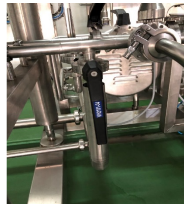
- เปิดวาล์ว VH2101-04 อยู่ระหว่างถังผสมกับสกรูปั่นด้านล่าง
