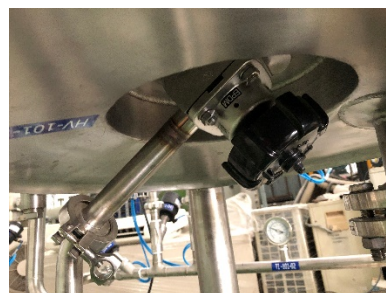
- เมื่อน้ำหมดถังปิดวาล์ว HV-101-18 ได้ถึง
