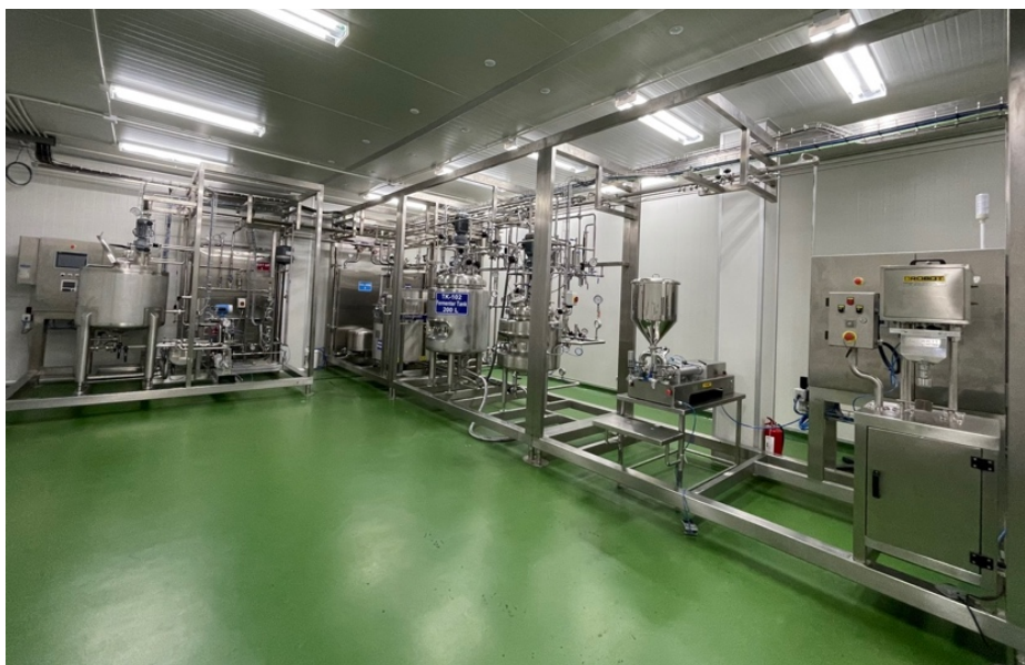
ภาพที่ 3.5 ชุดเครื่องจักร Functional Drink (โครงการเครื่องจักรตัวต่อ, Thailand)
