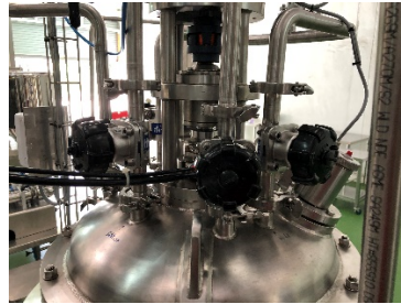
- ปิดวาล์ว HV-101-16 บนถังด้านหลัง
