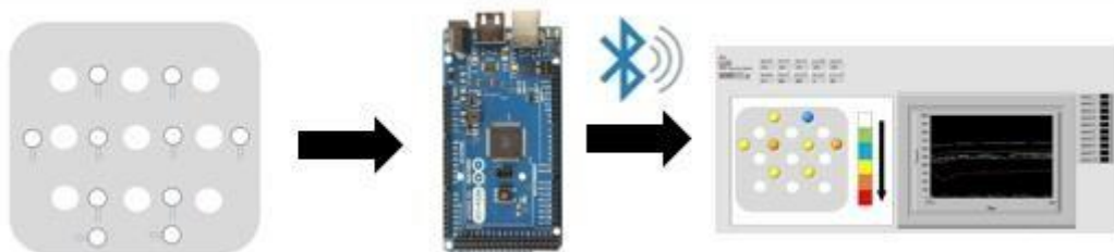
รูปที่ 3.22 แผนผังการทำงานของเครื่องวัดแรงกดผ่านเครือข่ายไร้สายสำหรับเบาะรองนั่ง
