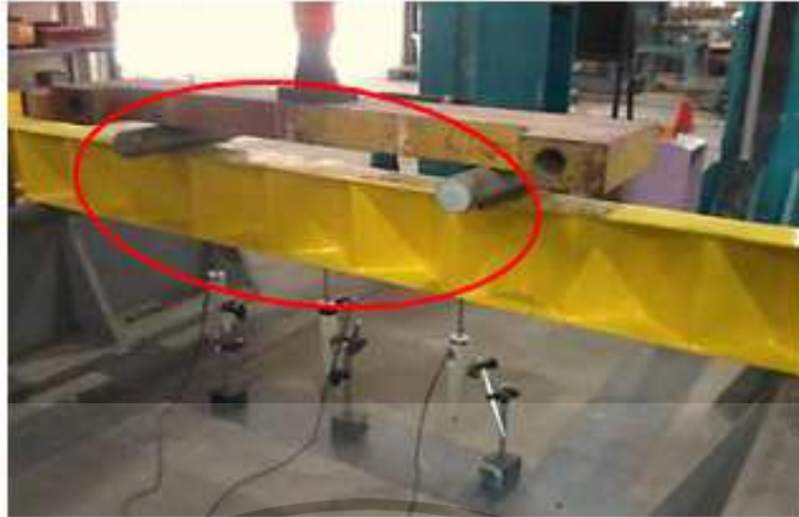
รูปที่ 9 คานที่มีแผ่นเอวรูปทรงสามเหลี่ยม ในการทดสอบแบบ four-point bending test [10]
