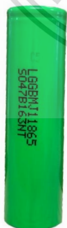
รูปที่ 3.1 แบตเตอรี่ลิเทียมไอออน LGGBMJ11865 และคุณสมบัติที่สำคัญ
