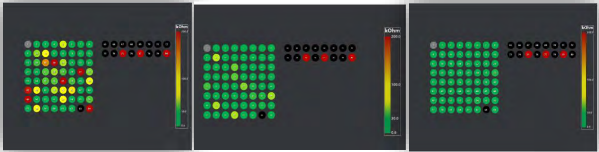
รูปที่ 3.5 การตั้งค่าอิมพีแดนซ์ของเครื่องวัดคลื่นสมอง ต้องไม่เกิน 5 กิโลโอห์ม
