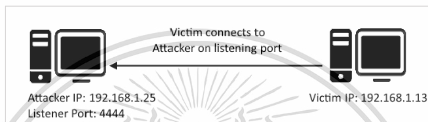
รูปที่ 2.5 การทำงานของ Reverse Shell
