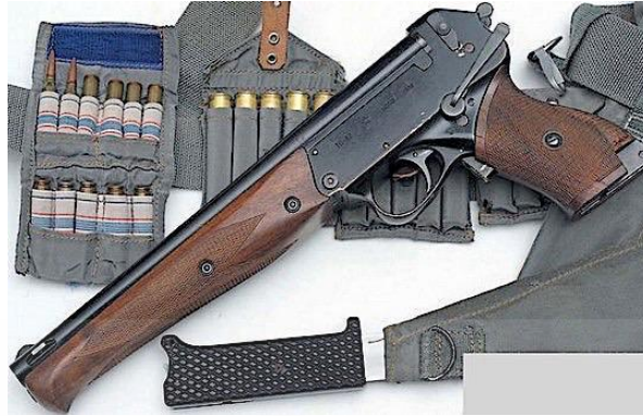
ภาพที่ 1.4.1 ปืน 3 ล้ากล้อรุ่งน TP 82 พร้อมกระสุนขนาด 12.5 x70 มม. และ 5.45 x39 มม
