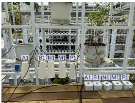
ภาพที่ 3.5 แสดงขั้นตอนการสอบเทียบเครื่องมือและอุปกรณ์ ณ ตำแหน่งจุด N1 ตั้งแต่วันที่ 13/01/2567 18.00 น. ถึง 14/01/2567 18.00 น.
