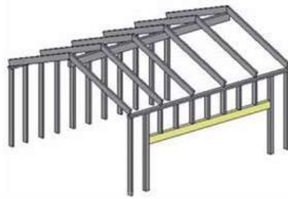
รูปที่ 2. 23 Lintel Beam
