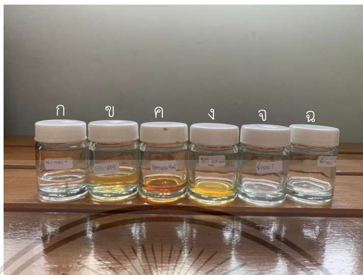
รูปที่ 4.4 สีของตัวอย่างที่ผ่านคอลัมน์กระบอกฉีดยาที่ใช้โม่บายเฟส เฮกเซน(ก) , เอทิล อะซีเตท(ข) , เอทานอล(ค) , 50%เอทานอล(ง) , น้ำครั้งที่1(จ) และ น้ำครั้งที่2(ฉ) ตามลำดับ
