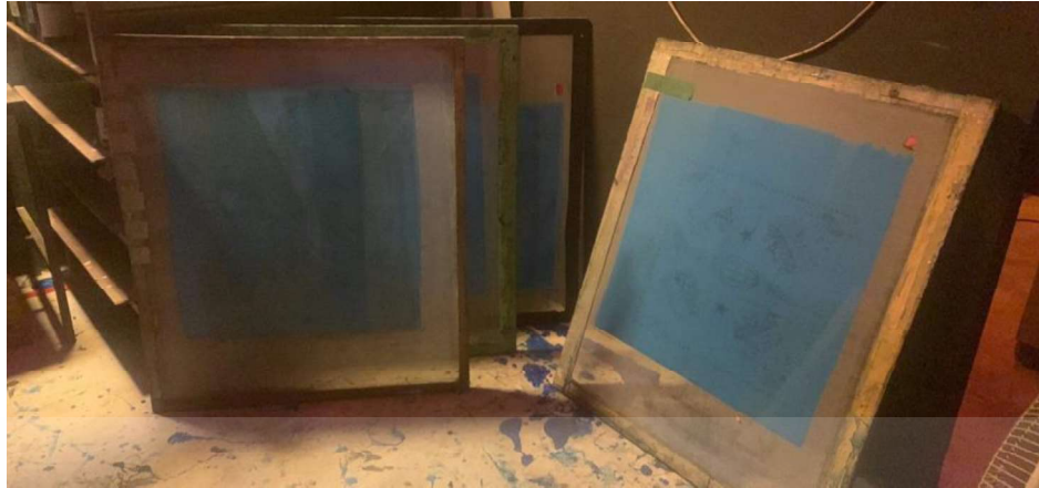
ภาพที่ 3.25 ตากบล็อกสกรีนหลังจากปาดกาว
