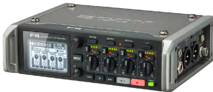
ภาพที่ 6.30 เครื่องบันทึกเสียง Zoom F4 (ที่มา https://zoomcorp.com/en/us/field-recorders/field-recorders/f4-field-recorder/ )
