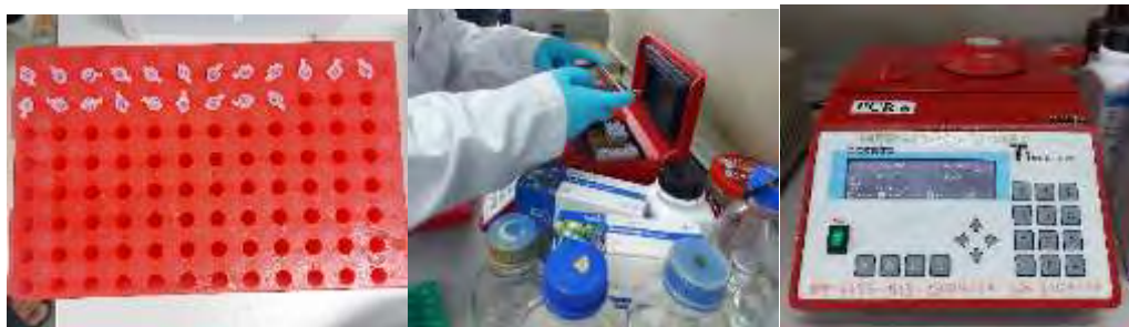
ภาคผนวกที่ ก 4 การนำหลอดสารเคมีที่ใช้สำหรับวิเคราะห์ PCR เข้าสู่เครื่อง Thermocycler หรือ PCR machine เพื่อเพิ่มสารพันธุกรรม
