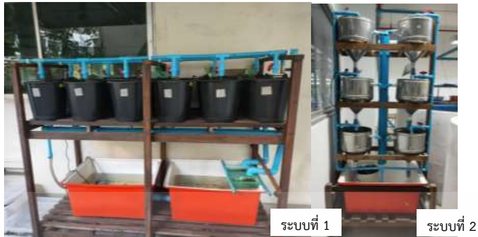
ภาพที่ 3.3 ระบบหมุนเวียนน้ำแนวตั้งการทดลองครั้งที่ 3 (ระบบที่ 1; ถังพลาสติก ระบบที่ 2; กรวยสแตนเลส)
