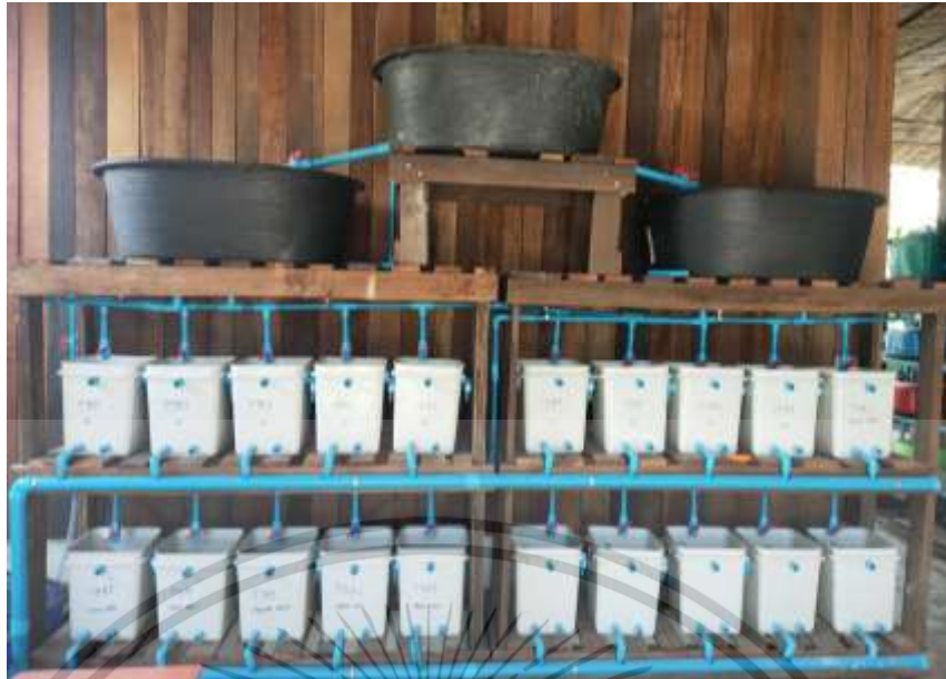
ภาพที่ 3.1 ระบบหมุนเวียนน้ำแนวตั้งการทดลองครั้งที่ 1
