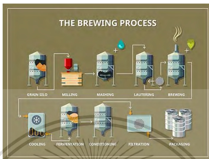
รูปที่ 2.9 แผนผังกระบวนการผลิตเบียร์ ที่มา : Hopbeerhousekorat (2021)
