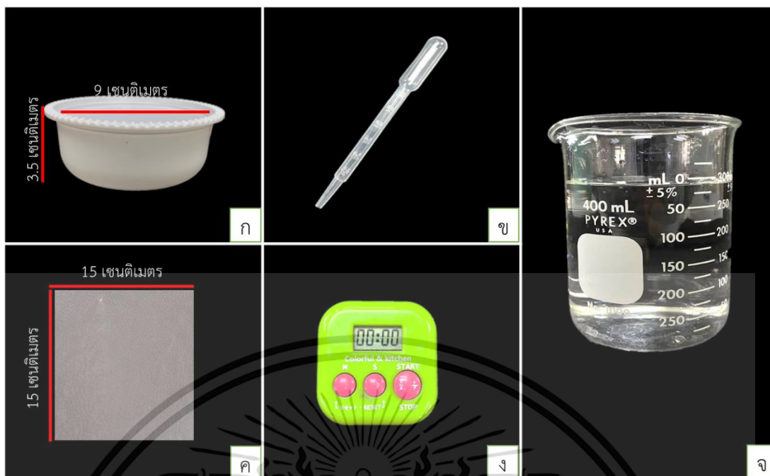
ภาพที่ 3.5 อุปกรณ์ที่ใช้ในการทดสอบประสิทธิภาพของน้ำมันหอมระเหยจากพืชผสมกับสารองค์ประกอบหลัก ต่อการป้องกันกำจัดของลูกน้ำวัย 4 และตัวโม่งของยุงลายบ้าน และศึกษาความเป็นพิษต่อลักษณะทางสัณฐานและสรีรวิทยาของยุงลายบ้าน : ก) ถ้วยพลาสติก ขนาดเส้นผ่านศูนย์กลาง 9 เซนติเมตร สูง 3.5 เซนติเมตร ข) หลอดดูด (Dropper) ค) ผ้าตาข่าย 15×15 เซนติเมตร ง) นาฬิกาจับเวลา และ จ) น้ำปราศจากคลอรีน
