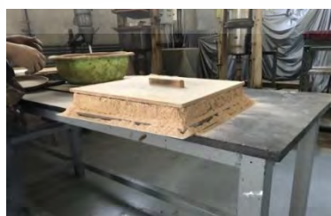
ภาพที่ 4.19 การเตรียมอัดขึ้นแผ่น
