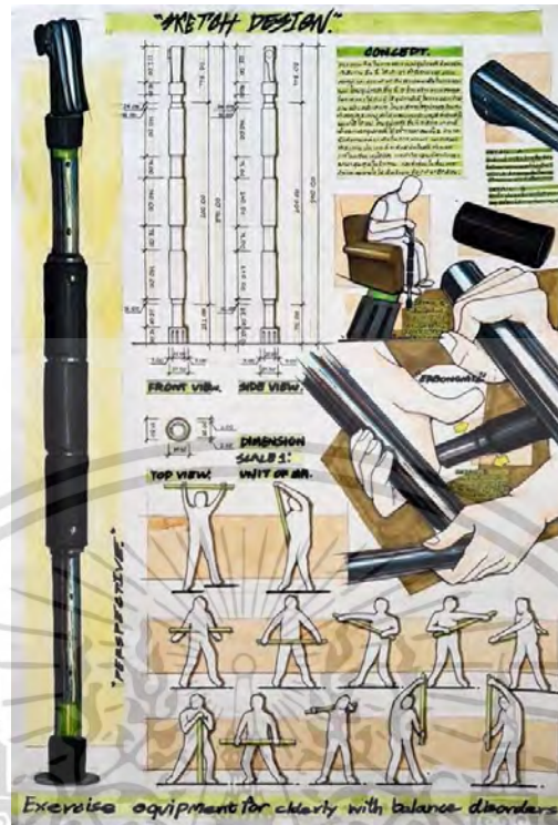
ภาพที่ จ.9 Sketch Design ภาพผลิตภัณฑ์อุปกรณ์ช่วยในการออกกำลังกายสำหรับผู้สูงอายุที่มีภาวะผิดปกติทางการทรงตัว
