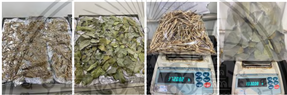
รูปภาคผนวก ง ที่ 2 นำส่วนของกิ่ง และใบของต้นมะหาดมาอบที่อุณหภูมิ 55 องศาเซลเซียส
