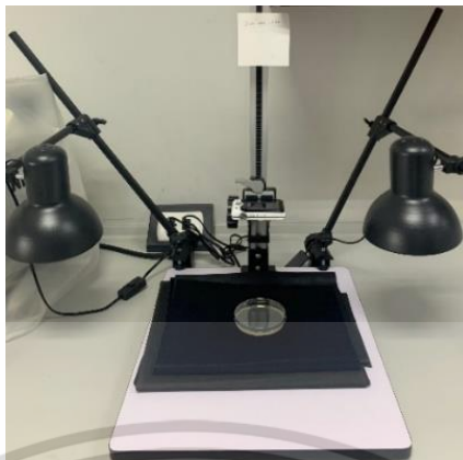
รูปที่ 3.2 อุปกรณ์ในการถ่ายรูปชิ้นงานตัวอย่างแผ่นไฮโดรเจล
