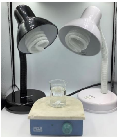
รูปที่ 3.1 ชุดการทดลองเพื่อศึกษาการย่อยสลายออกซีเตตราซัยคลิน ด้วยปฏิกิริยาทางแสงโดยใช้ PVP-BiOBr@rGO
