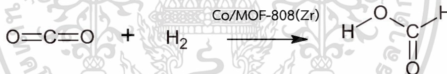
รูปที่ 2.7 ตัวอย่างปฏิกิริยาไฮโดรจิเนชันจากคาร์บอนไดออกไซด์เป็นกรดฟอร์มิก
