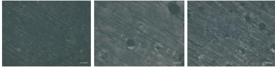
รูปที่ 4.8 ใยฝ้ายธรรมชาติที่ไม่ใส่ตัวทำละลายร่วม จากภาพกำลังขยาย 50, 100, 200 เท่า ตามลำดับ
